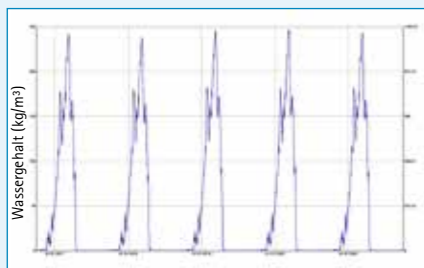
Abb. 17 / Fall 4 : Wassergehalt im Auswertungsbereich der Gefachdämmung beispielhaft in der Klimazone HRY 7.
