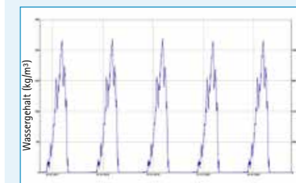
Abb. 20 / Fall 5: Wassergehalt im Auswertungsbereich der Gefachdämmung beispielhaft in der Klimazone HRY 7.
