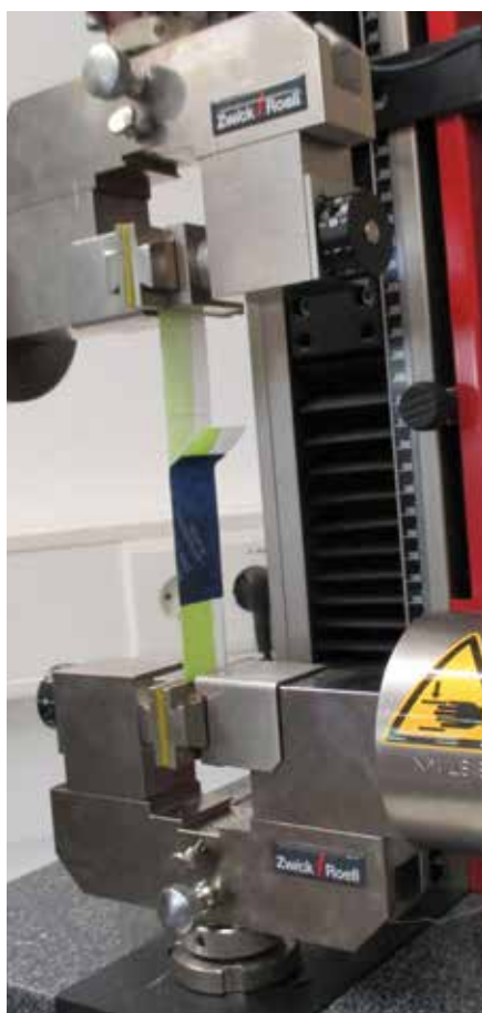
In der kommenden Norm DIN 4108-11 werden Labortest festgelegt, die für alle Klebebänder durchgeführt werden müssen. So gibt es einheitliche Qualitätsstandards und Vergleichsmöglichkeiten für den Anwender.
