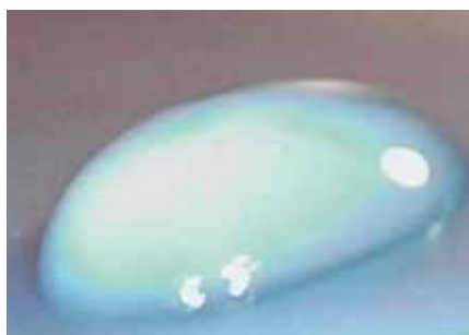
Schwache Benetzung und schlechte Verklebbarkeit bei dieser PE-Luftdichtungsbahn: ca. 35 \text{ N/mm}^2
