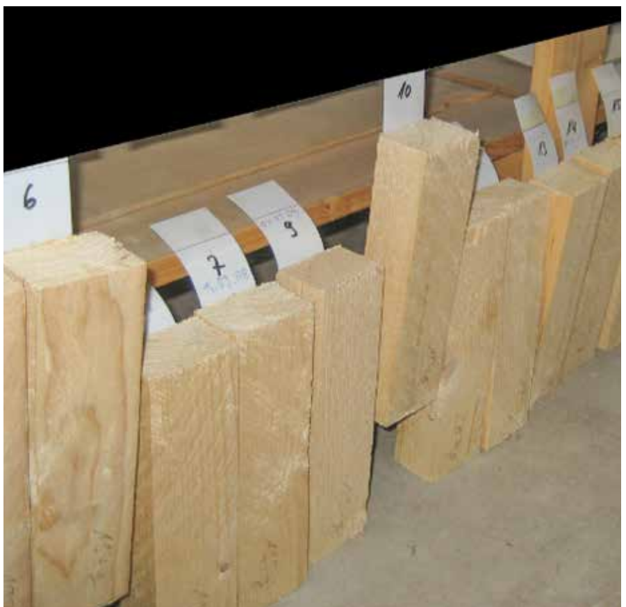
Kohäsions-Klebetest mit 47 Klebebändern: Bei einem Langzeittest mit einer geringen Belastung versagten innerhalb von zwei Jahren 40 Klebebänder.
