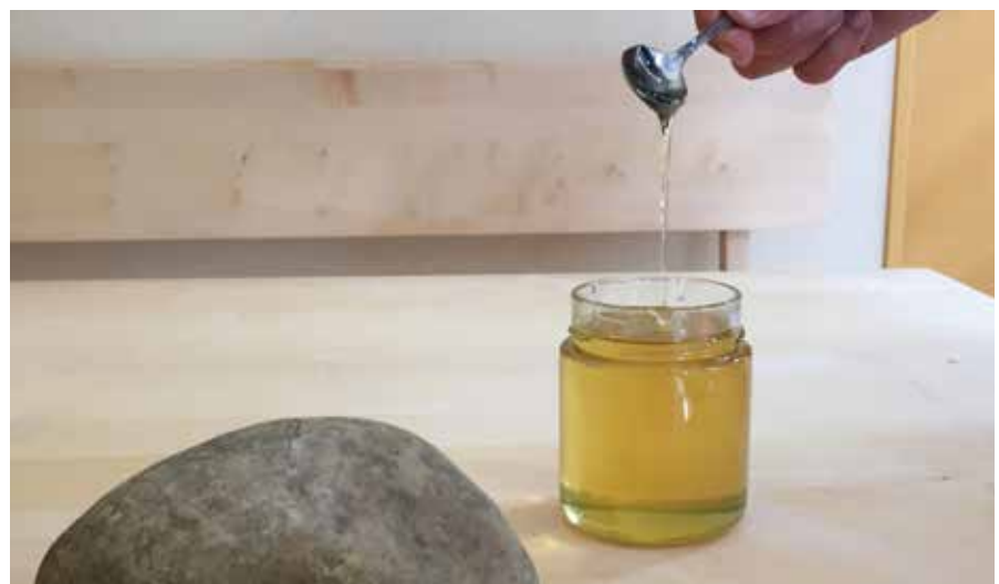
Honig hat eine hohe Adhäsion – er klebt daher sofort an jeder Oberfläche. Die Kohäsion ist gering, sodass der Honig alleine durch sein Eigengewicht von der Oberfläche tropft. Das genaue Gegenteil: der Stein. Dieser hat eine hohe innere Festigkeit, also Kohäsion, aber verfügt über keinerlei Adhäsion und klebt daher nicht an Oberflächen.
